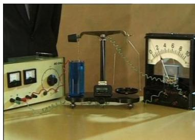
Рис. 6. Фрагмент видеофильма «Электролиз раствора сульфата меди (II). I закон Фарадея»
