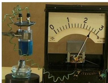
Рис. 4. Зависимость электропроводности электролита от температуры
